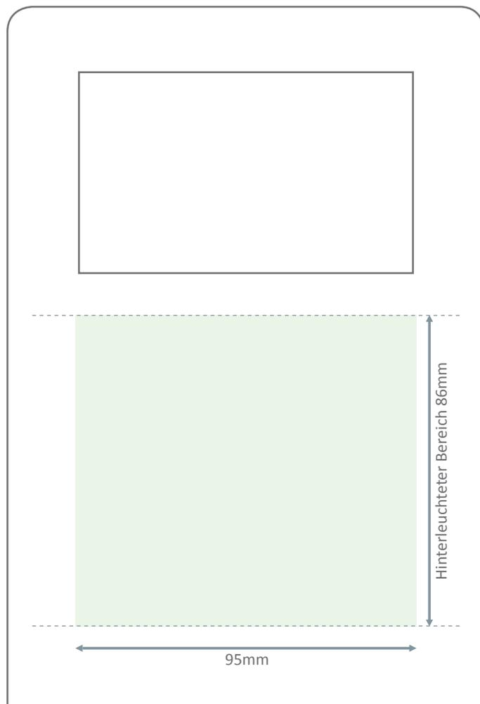
Die Touchscreen-Fläche zur Bedienung des Gerätes erstreckt sich über einen Bereich von 95mm x 156mm und umfasst auch den Bereich des Displays.
